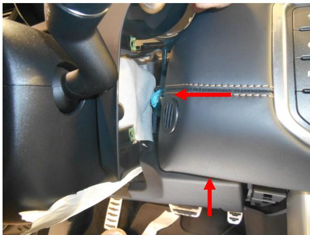
Вывернуть саморез, снять панель, вывернуть саморез.
