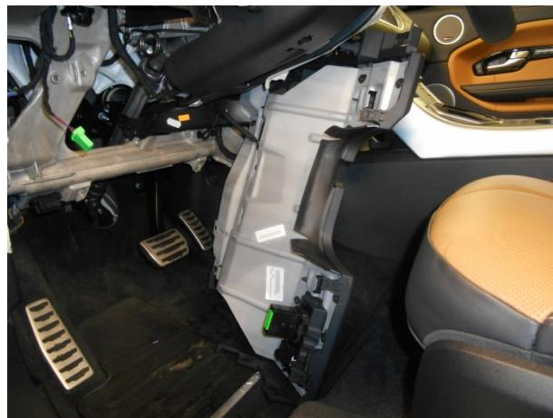
Отсоединить фишку, снять панель, отвести в сторону.
