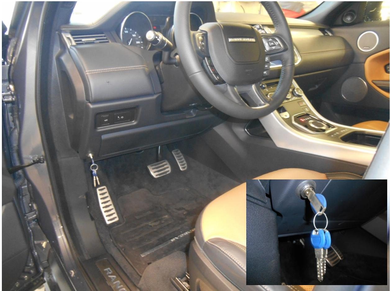
Одеть метку и разметить панель. Выполнить в ней отверстие, одеть декоративную накладку.
