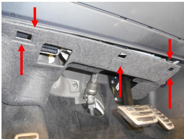
Выдернуть 3 клипсы, снять панель,
