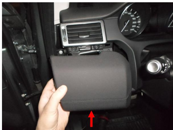
Снять панель, вывернуть саморез.
