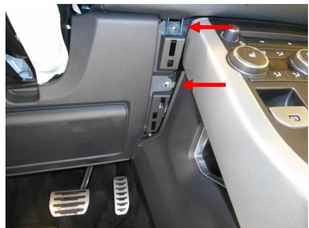
Снять панель, вывернуть 2 самореза.
