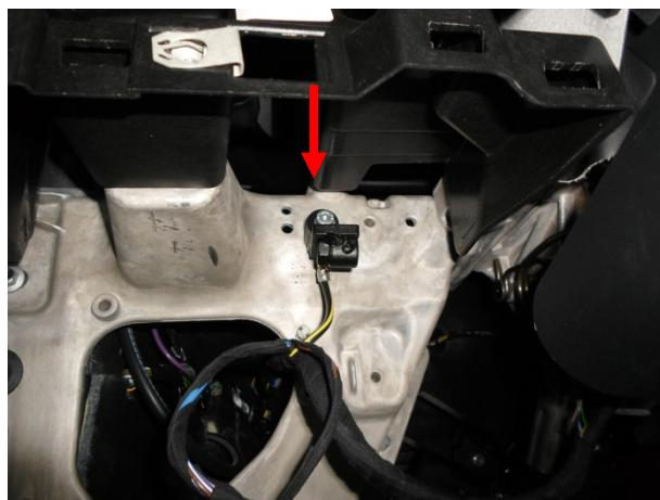
Установить дополнительную пластину.
